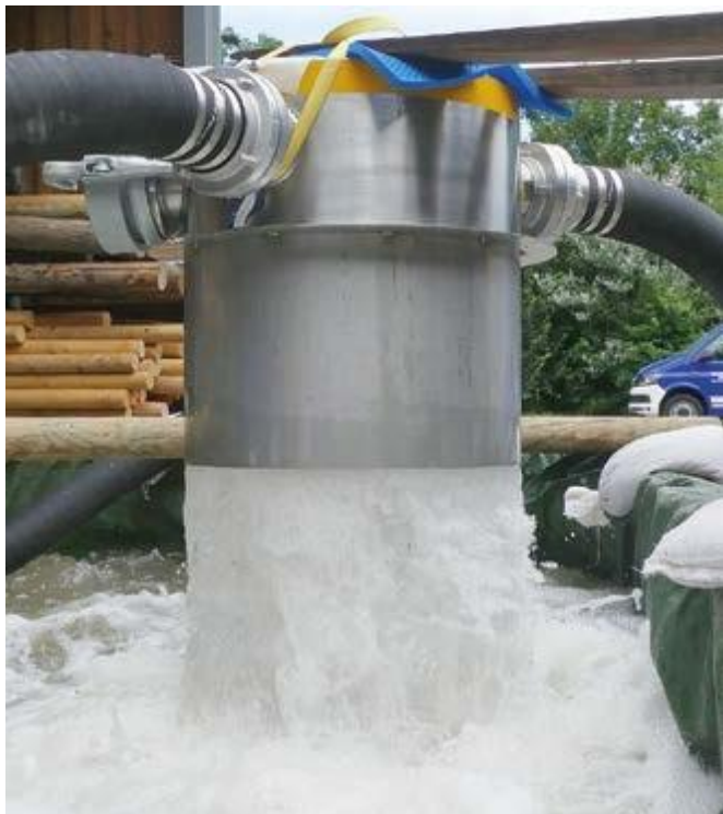
Die SET vermindert den Druck des ankommenden Wassers (hier etwa 6 000 l/min), weil jeder Wasserstrahl auf eine Wand trifft. Konstruktion und Wirkungsweise der SET sind EU-weit patentrechtlich geschützt. (Foto: Faszitech UG)
