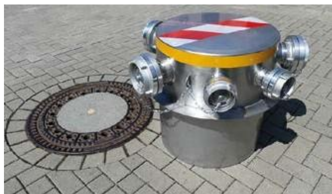
Eine Schacht-Einlauftonne Typ A: Unterhalb der zwei B- und vier A-Storz-Anschlüsse befindet sich der Auflagering, der auf jeden genormten Schacht passt. Durch Reflektionsstreifen ist die Tonne auch bei Nacht gut zu erkennen. (Foto: www.faszitech.de)
