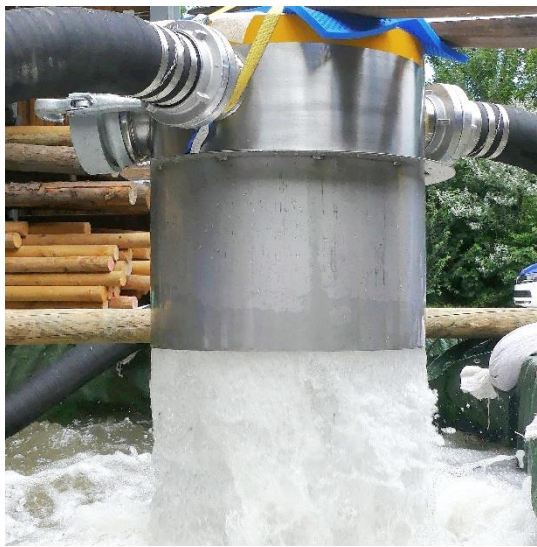
Foto: Schacht-Einleitung - Abflussbild bei 6.000 L/Min
